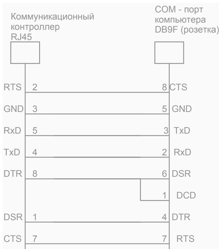
Рис 2. Кабель для подключения коммуникационного контроллера к COM- порту компьютера по интерфейсу RS232
