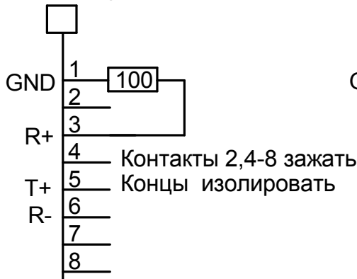
Заглушка "CL20mA" 2-проводный вариант RJ45 (plug)
