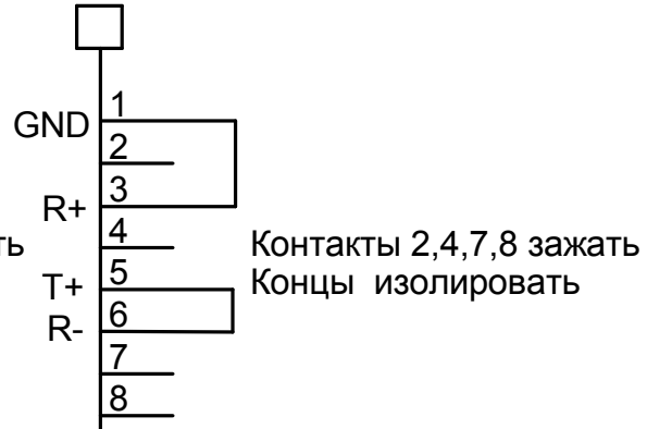
Заглушка "CL20mA" 4-проводный вариант RJ45 (plug)
